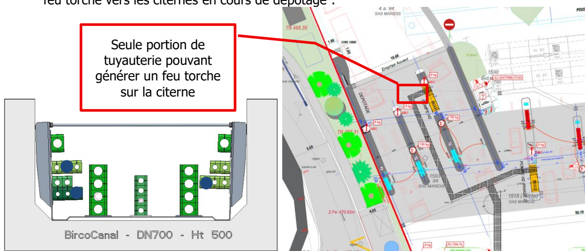
Figure 12 : Position des tuyauteries hydrogène dans les caniveaux et sur site
